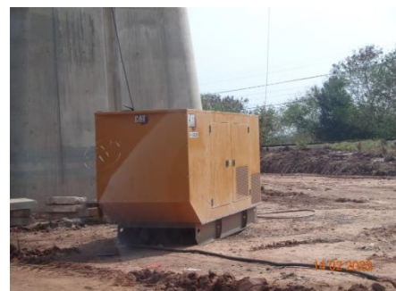
ภาพที่ 2.2-22 เครื่องจักรที่มีอุปกรณ์ลดความดังของเสียงที่แหล่งกำเนิด
