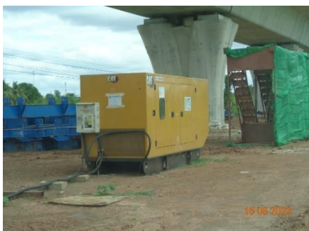
ภาพที่ 2.2-22 เครื่องจักรที่มีอุปกรณ์ลดความดังของเสียงที่แหล่งกำเนิด
